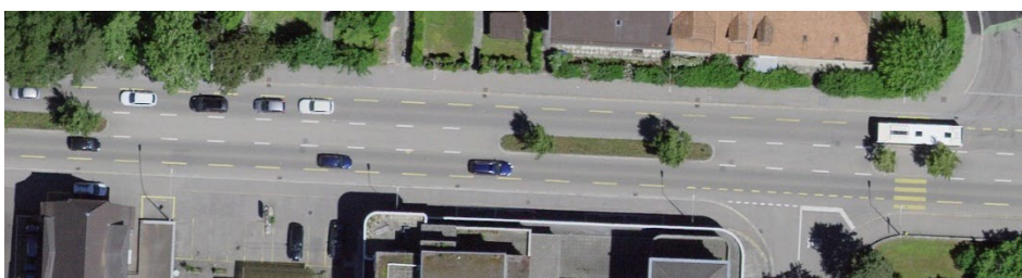
Abbildung 23: Bielstrasse Solothurn (Mittelbereich mit Mehrzweckstreifen / Bäumen und Radstreifen)
