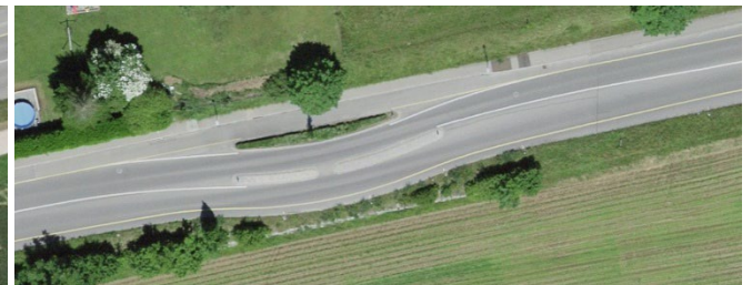
Abbildung 21: Pieterlen, Ortseingang Ost (einfache Verschwenkung der Fahrbahn)
